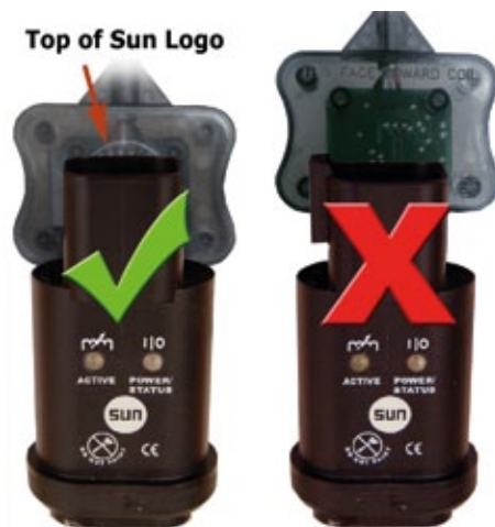
Bild 18: Korrekte und falsche Ausrichtung des IR-Adapters beim integrierten Verstärker.
