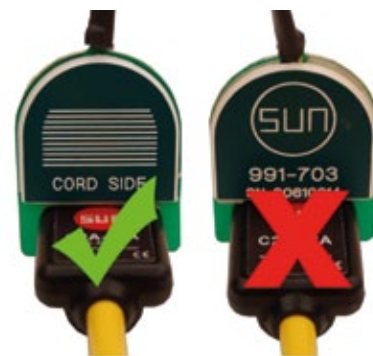
Bild 19: Korrekte und falsche Ausrichtung des IR-Adapters beim Steckerverstärker.
